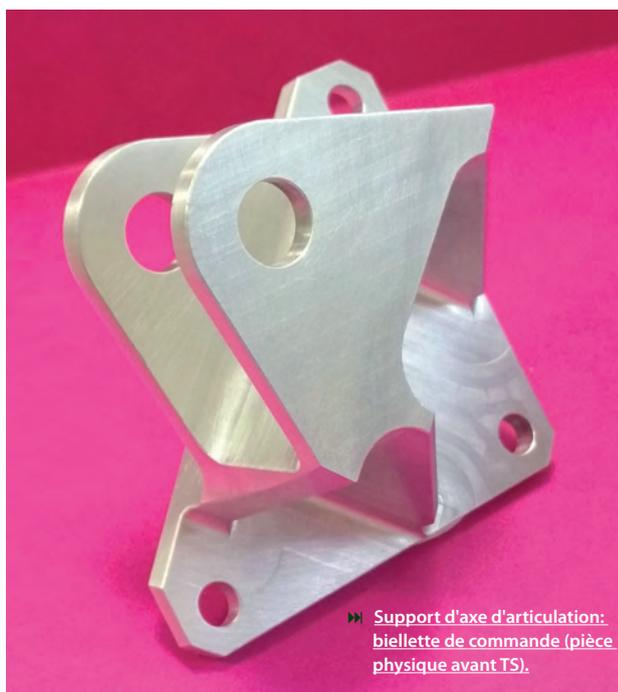
► Support d'axe d'articulation: biellette de commande (pièce physique avant TS).
